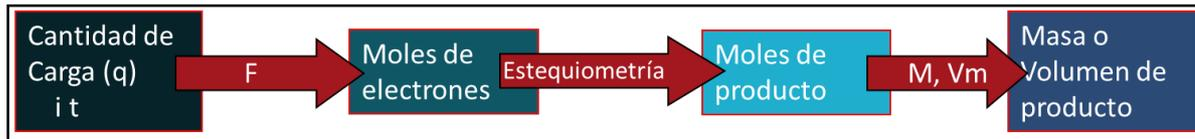
Figura 4. Cálculo de la cantidad de producto obtenido en una electrólisis
