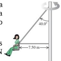
5. En un “columpio gigante”, el asiento está conectado a dos cables (figura), uno de los cuales es horizontal. El asiento gira en un círculo horizontal a 32rpm. Si el asiento pesa 255N y una persona de 825N está sentada en él, obtenga la tensión en cada cable.
