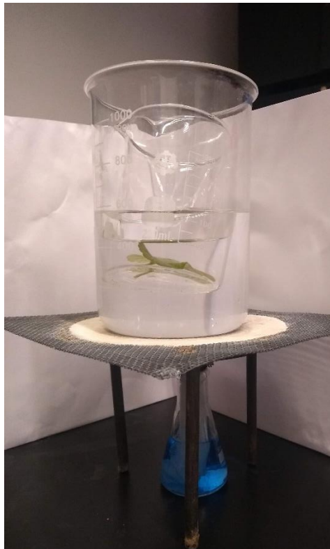
Imagen N°2: Sistema de vasos de precipitados a baño maría
