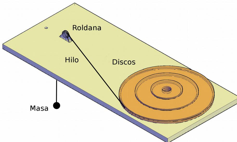
Figura 1: esquema del sistema de rotaciones.
