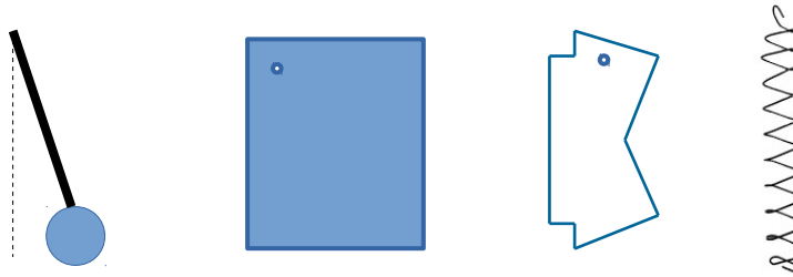
Figura 1: esquema de los materiales; de izquierda a derecha: péndulo simple, placa rectangular de madera, placa de forma irregular de madera, resorte.
