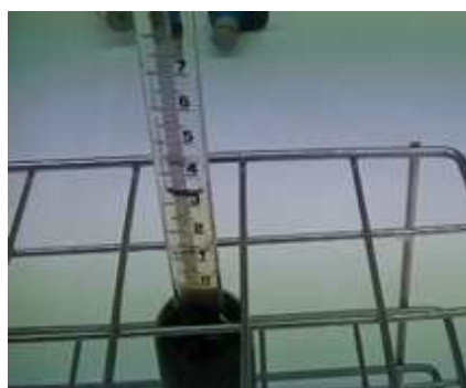
Nivel de grasa en el butirómetro
