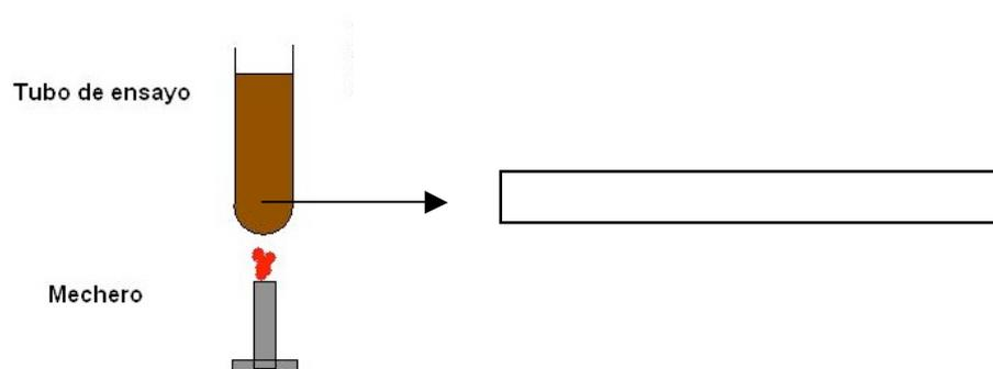
Sujete el tubo de ensayo con una pinza de madera y caliente el tubo directamente sobre la llama del mechero.
