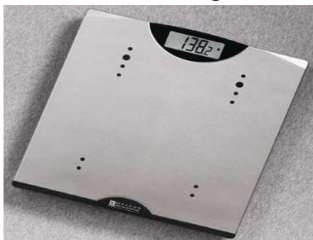
En los instrumentos digitales la lectura es directa como así también el valor central de la medición. Generalmente el valor de la precisión suele venir especificado por el fabricante en el instrumento. En caso que no tengamos este dato, la precisión es la mitad del valor del último dígito. Por ejemplo, para el caso de la figura, la balanza está marcando  $m = 138.2 \text{ g}$ , el último dígito que puede medir es la décima de gramo (0.1g), entonces el error sería  $\pm 0.05 \text{ g}$ .
