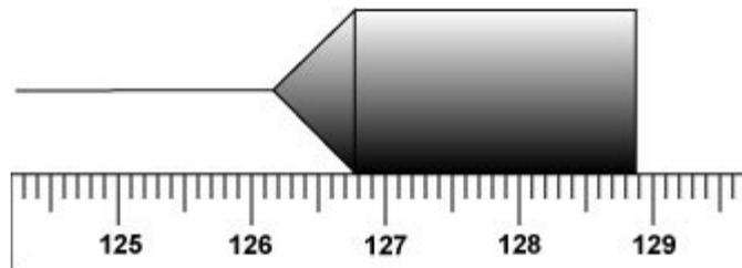
Este es el error mas común cometido al realizar una lectura de la escala. Por ejemplo cuando medimos la longitud de un péndulo que pivotea del extremo de una masa (Ver figura ) vemos que la medición está entre 128.88 y 128.89. Podemos ver que el valor de confianza mas de la longitud puede expresarse de la siguiente manera:
