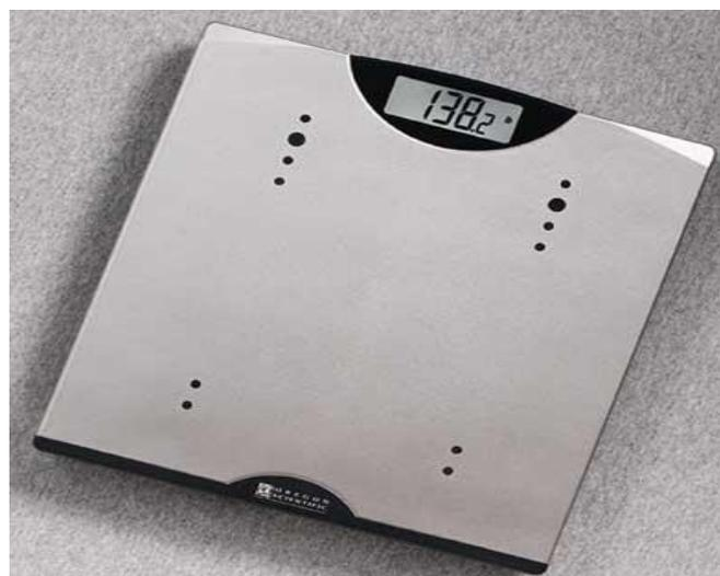
En los instrumentos digitales la lectura es directa como así también el valor central de la medición. En estos instrumentos generalmente el valor de la precisión suele venir especificado por el fabricante en el instrumento. En caso que no tengamos este dato la precisión es la mitad del valor del último dígito. Por ejemplo para el caso de la figura la balanza está marcando 138.2 lb y la precisión sería  $\pm 0.05$  lb.
