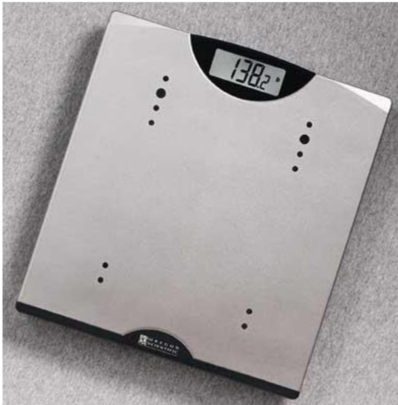
En los instrumentos digitales la lectura es directa como así también el valor central de la medición. En estos instrumentos, por lo general, el valor de la precisión suele venir especificado por el fabricante en el mismo instrumento. En caso de que no tengamos este dato, el error de apreciación es la mitad del valor del último dígito. Por ejemplo, para el caso de la figura la balanza está marcando 138.2 lb y la precisión sería  $\pm 0.05$  lb, por lo que la medición se puede reportar como:
