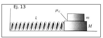
está sobre el primero. El coeficiente de fricción estática entre los bloques es  $\mu_e$ . Determine la amplitud de la oscilación máxima que no permite que el bloque superior resbale.
