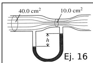
16. El tubo horizontal de la figura tiene un área transversal de  $40\text{ cm}^2$  en la parte más ancha y de  $10\text{ cm}^2$  en la constricción. Fluye agua en el tubo, cuya descarga es de  $6 \times 10^{-3}\text{ m}^3/\text{s}$  ( $6\text{ L/s}$ ). Calcule a) la rapidez del flujo en las porciones ancha y angosta; b) la diferencia de presión entre estas porciones; c) la diferencia de altura entre las columnas de mercurio en el tubo con forma de U.
