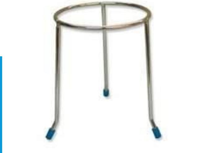
Es un aparato de tres patas y parte superior circular o triangular, que permite estabilizar un objeto y evitar el movimiento propio de este.
