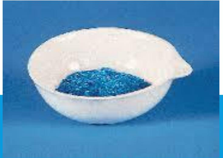
Capsula de porcelana: Se utiliza para la separación de mezclas por evaporación y para someter al calor a muestras a altísimas temperaturas.
