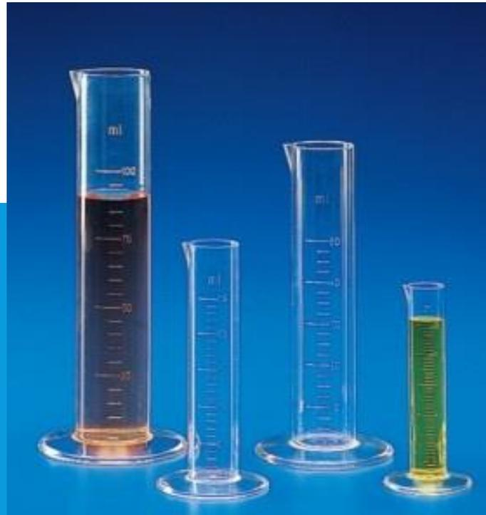
Es un tubo cilíndrico graduado que permite medir un volumen aproximado, ya sea gas o líquido.
