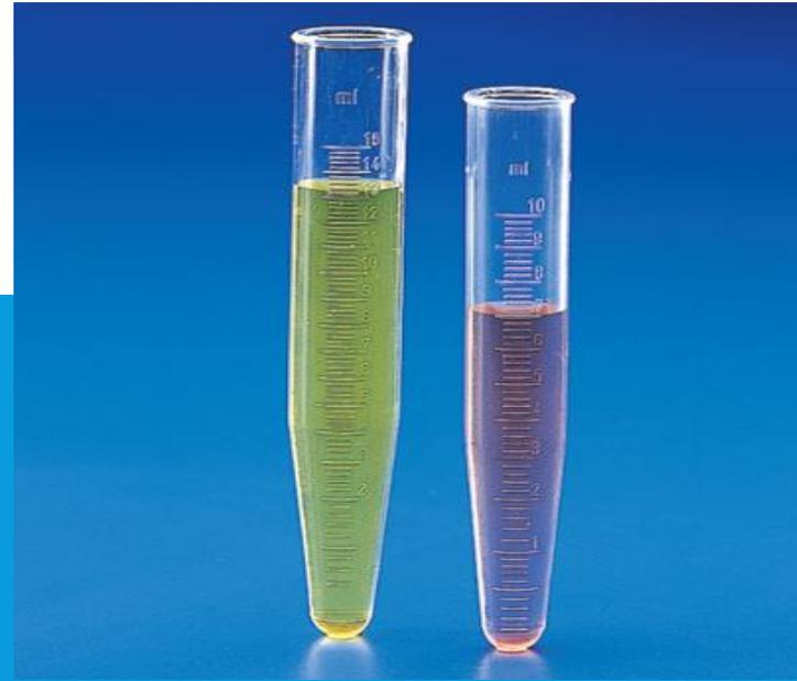
Facilita la separación de un sólido en suspensión de un líquido.
