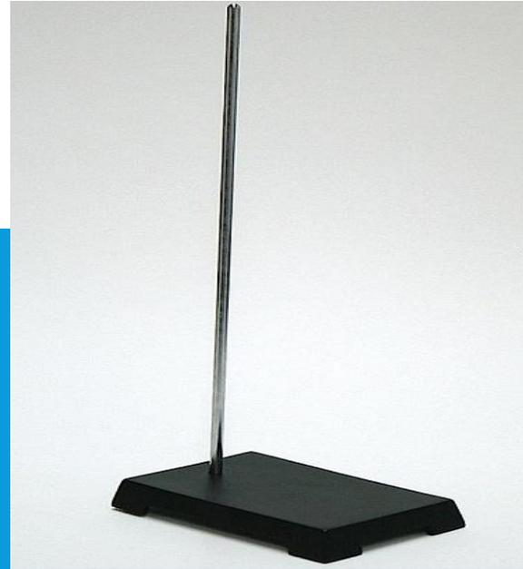
Es una pieza del equipamiento de laboratorio donde se sujetan las pinzas de laboratorio, mediante dobles nueces. Sirve para sujetar tubos de ensayo, buretas, embudos de filtración, etc.
