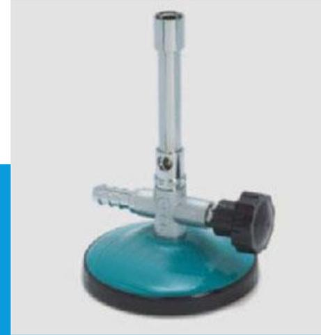
Es un instrumento utilizado en los laboratorios científicos para calentar o esterilizar muestras, también producir reacciones que necesiten temperaturas no muy elevadas.
