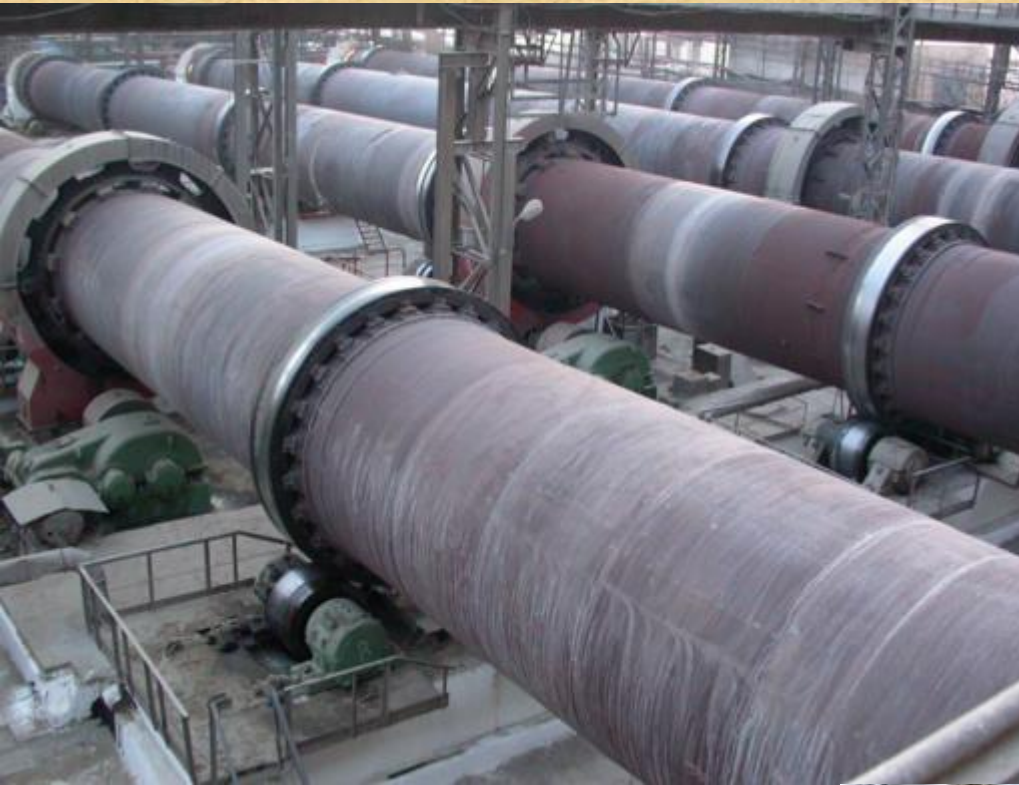
Horno tubular rotatorio. Llama directa
