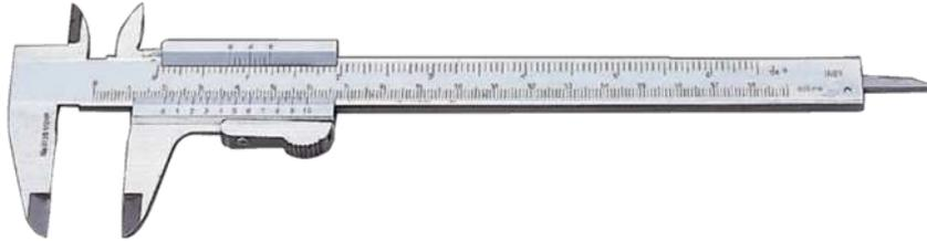
Suponga que se utiliza un calibre para medir el diámetro “d” de un pistón de una motocicleta. Considere que la mínima escala que distingue este instrumento es de una décima de milímetro. Se observa que el valor más aproximado de la medición es de 22,9mm.
