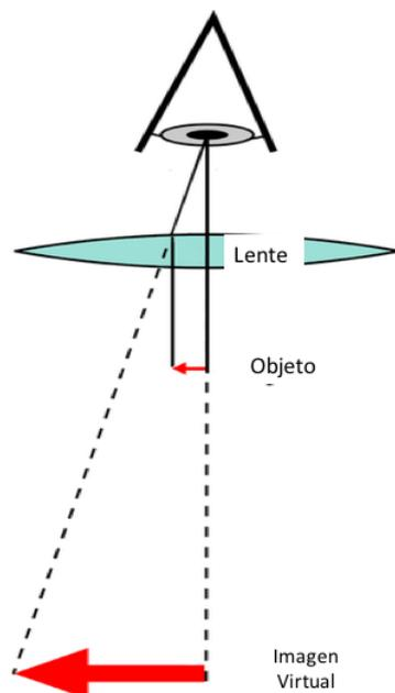
**Diagrama óptico de un microscopio simple.**
