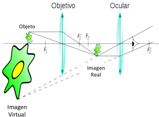
*Diagrama óptico de un microscopio compuesto.*
