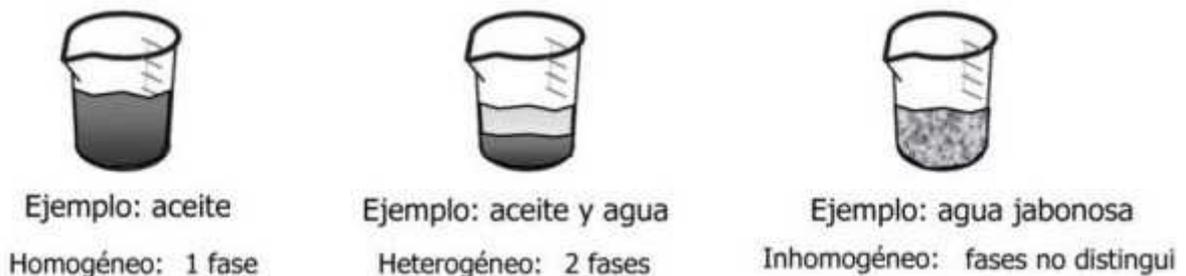
Figura 10: clasificación de los sistemas materiales en función de su composición.
