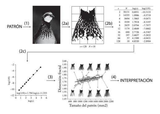
**Figura 1.**Metodología general utilizada para el cálculo de la 'dimensión fractal' en biología. Ver la explicación en el texto. Notar que en este ejemplo nuestro  $N_{\delta}(F)$  es N y  $\delta$  es s. Los autores calcularon  $\log(1/N)$  vs.  $\log(s)$  en vez de  $\log N_{\delta}(F)$  vs.  $-\log \delta$ , pero el resultado es equivalente. Creado a partir de las figuras 1 y 2 de Pérez-Rodríguez *et al.* (2013).
